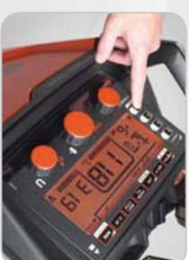
Модели Kemppi Adaptive (A) предлагают специальные функции, в том числе возможность установки мощности в зависимости от толщины листа, выбор присадочного материала и канала памяти.
