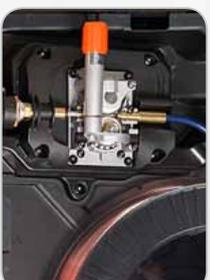
Модели Kemppi 181/251 включают механизм подачи проволоки GTD2 с приводом на два ролика.
