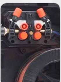
Модели Kemppi 253/323 включают механизм подачи проволоки Diataqonic с приводом на четыре ролика.
