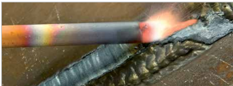
Аппарат KempGouge ARC 800 облегчает операции строжки угольной дугой.
