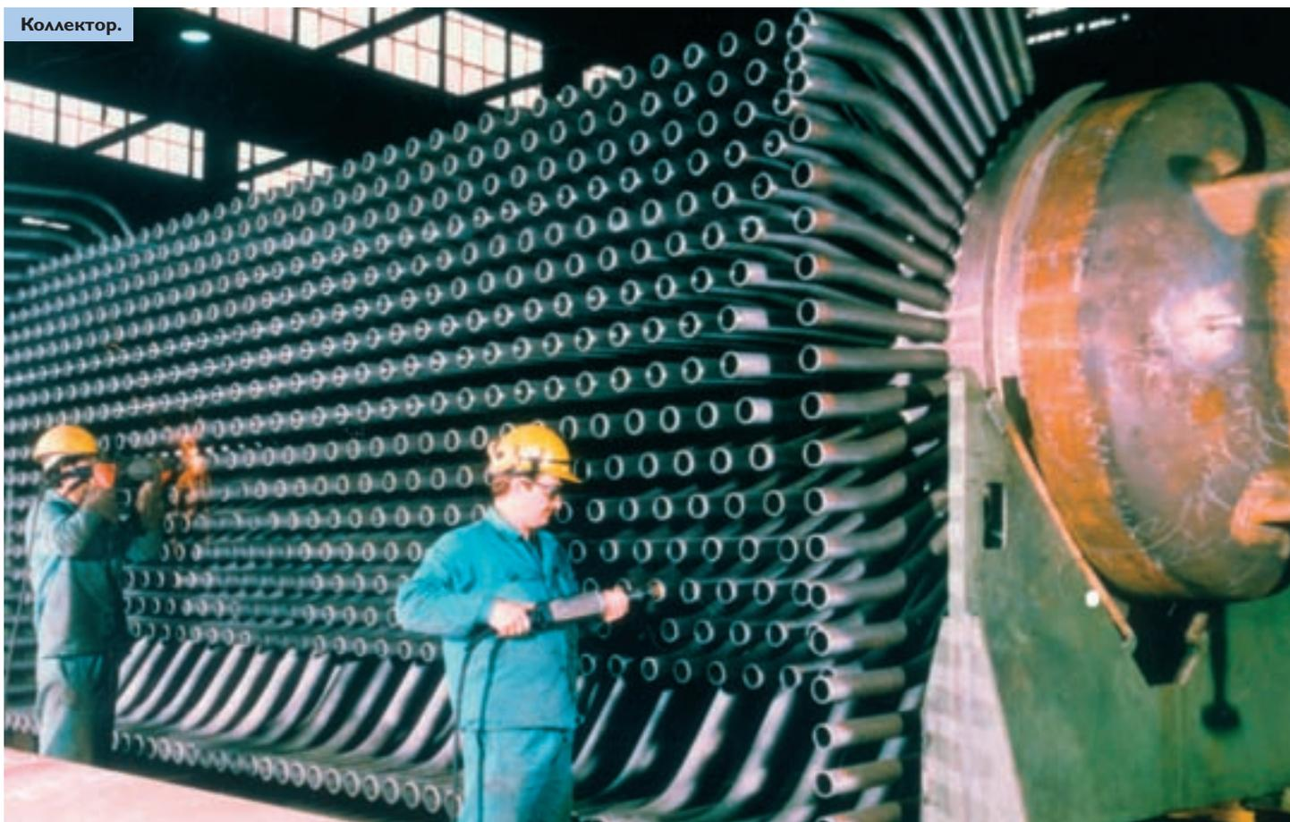
Соединительная сварка труб с коллекторами котла-утилизатора.
