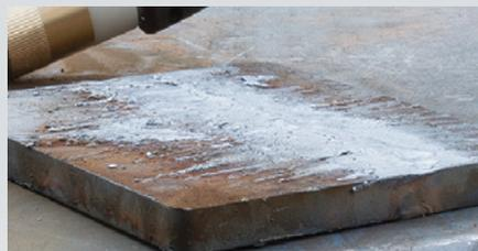
После среза крепления операторы могут снизить силу тока в системе и оплавить все остатки материала на заготовке, не прожигая ее. Оплавление материала, которое можно выполнить с использованием расходных деталей FlushCut, уменьшает необходимость в последующем шлифовании.
