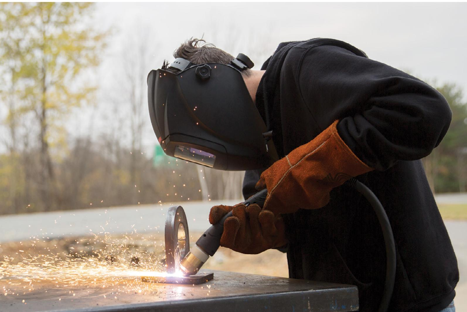
Процесс FlushCut™, который реализован в определенных системах Powermax, позволяет пользователям выполнять резку в такой близости к базовому металлу, которая ранее была недостижима.
