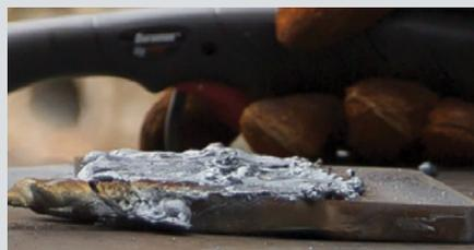
При использовании расходных деталей FlushCut операторы могут ожидать, что после среза проушин, креплений или монтажных петель на заготовке останется меньше 5 мм материала.
